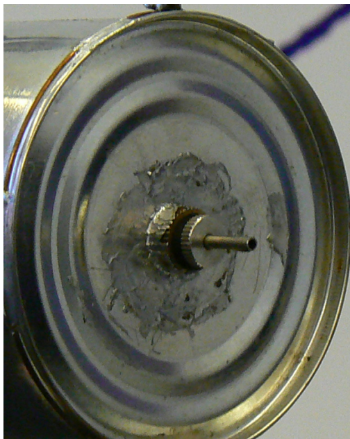
Abb. 3: Eingelöteter Gewintheadapter mit aufgeschraubter Düse
