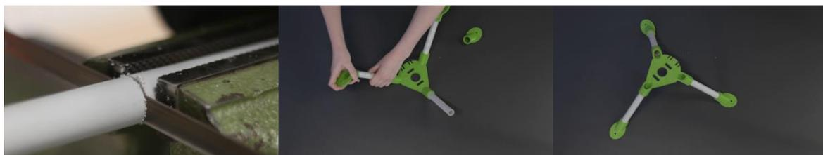
Den Schlauchverbinder und den Gartenschlauch an der Hauptplatte befestigen. Der 3D-gedruckte Schlauchbieger wird einfach um den Schlauch geklipst.
