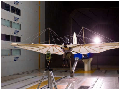
Abb. 2: Ein Nachbau von Otto Lilienthals Gleitflieger wird im Windkanal vermessen
