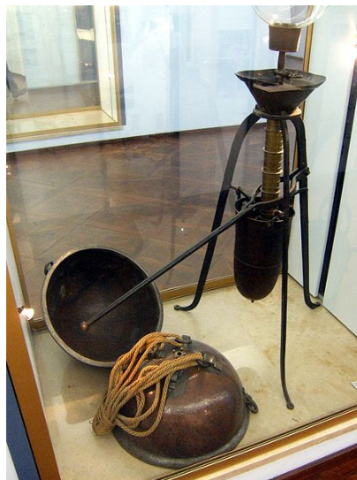
Magdeburger Halbkugeln samt Luftpumpe (Bild: LepoRello)
