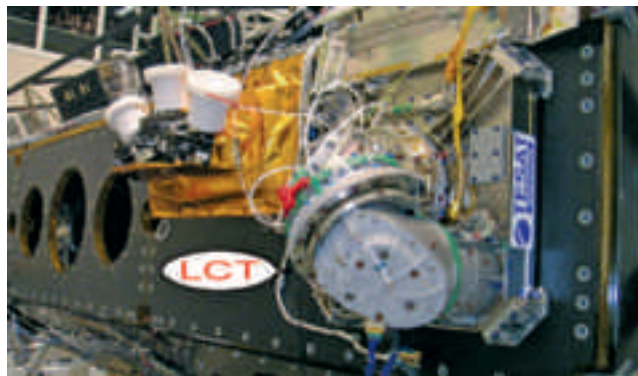
TerraSAR-X mit integriertem LCT während abschließender Tests bei EADS Astrium in Friedrichshafen (TESAT)
