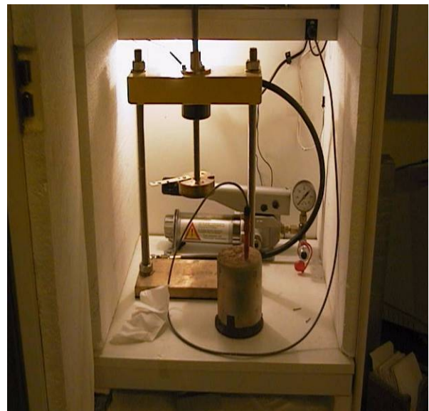
Bild 2.15 Messkonfiguration zur Bestimmung der Wärmeleitfähigkeit
