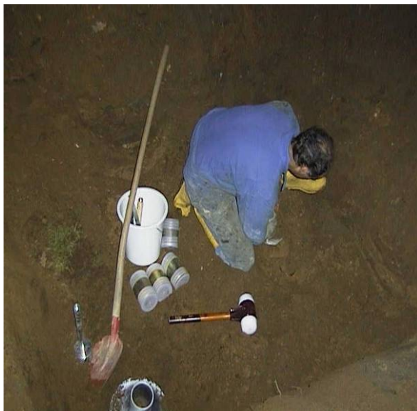
Bild 2.14 Entnahme der Bodenproben mittels Stechzylinder mit Leiner
