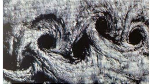
Durch das periodische Ablösen wird der Schlauch in Schwingung versetzt. Wie man im Versuch festgestellt hat, ist das Geräusch abhängig vom Durchmesser des Schlauches und von der Rotationsgeschwindigkeit. Weil die Schlauchgeschwindigkeit dicht am Mittelpunkt klein und außen groß ist, hört man nicht nur einen Ton sondern ein Gemisch von Tönen.
