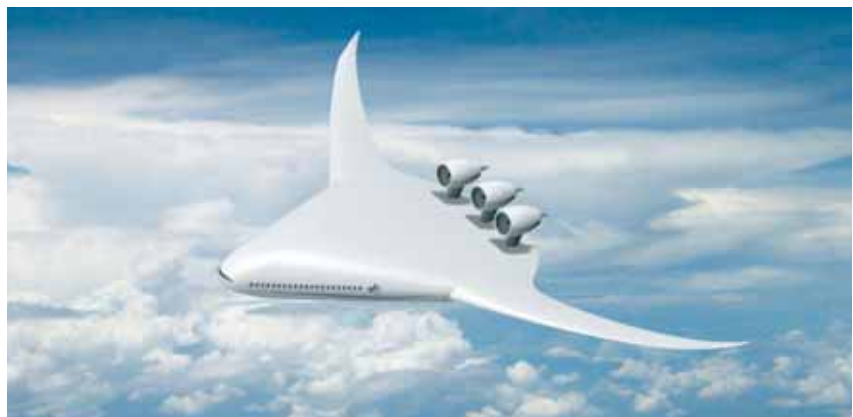
Abbildung 2: Simulation eines Flugzeugs mit einem Blended-Wing-Body. Der Rumpf geht fließend in den Flügel über.
