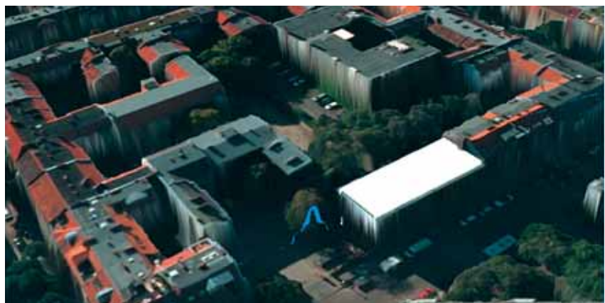
Abbildung 71: Erster Schnappschuss einer Visualisierung eines Stadtmodells (Berlin-Kreuzberg), mit Darstellung der expliziten Hülle eines Gebäudes aus einer City-GML-Datei.
