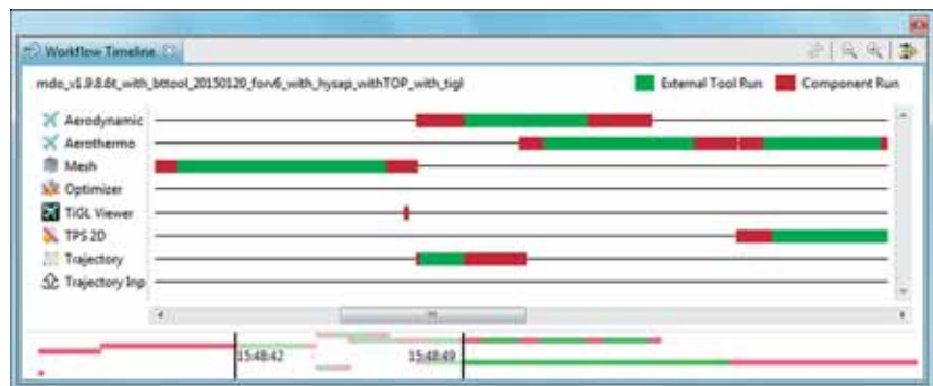
Abbildung 7: Zeitlicher Verlauf eines Workflows. Die Balken zeigen, wann ein Programm des Workflows wie lange ausgeführt wurde.
