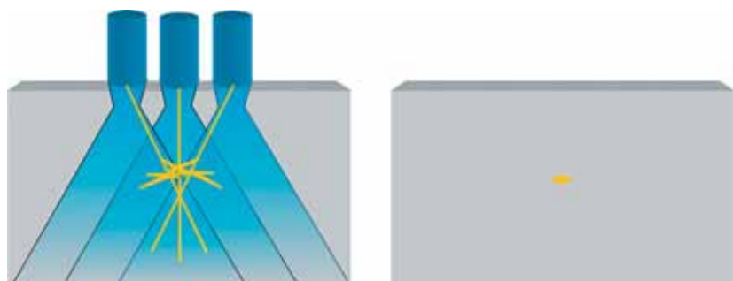
Abbildung 28: Konzept der zerstörungsfreien Materialprüfung mit Ultraschall (Quelle: BMBF-Projekt HPC-FLiS, SIEMENS AG, Corporate Technology).
