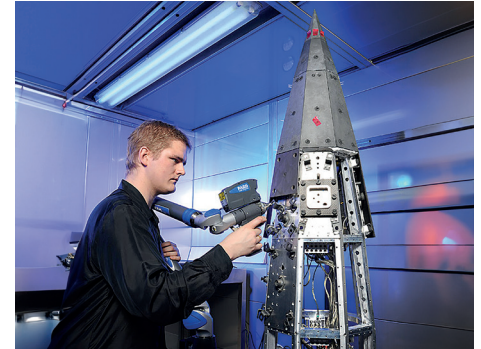
Montage der keramischen Thermalschutzelemente auf SHEFEX II
