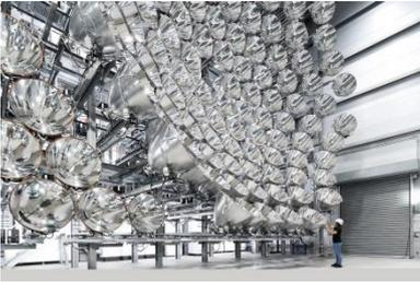
Mit dem Hochleistungsstrahler „Synlight“ erforscht das DLR Herstellungsverfahren für solare Treibstoffe wie Wasserstoff.
