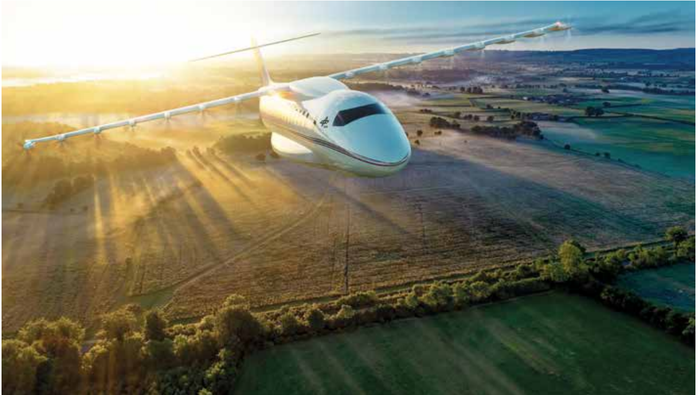
Elektrisches Fliegen ermöglicht neue Flugzeugkonfigurationen, zum Beispiel verteilte Propeller an der Flügelvorderkante
