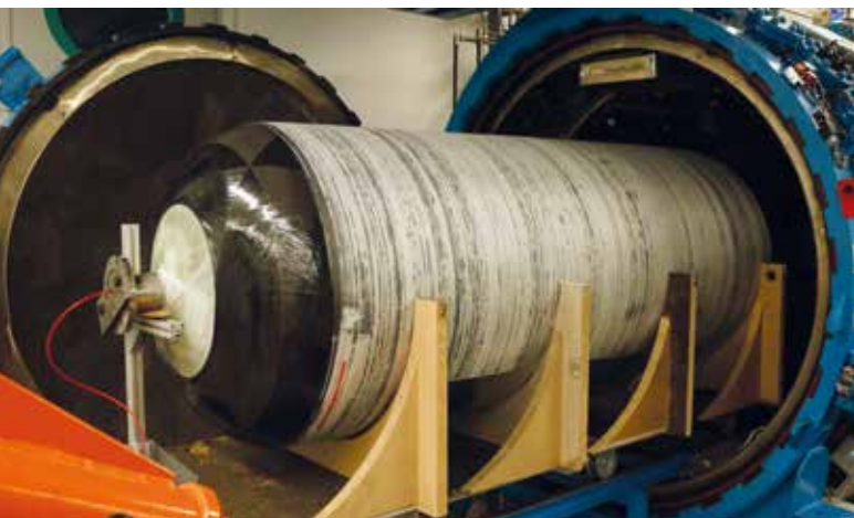
Ultraleichter CFK-Hochdrucktank für Wasserstoff
