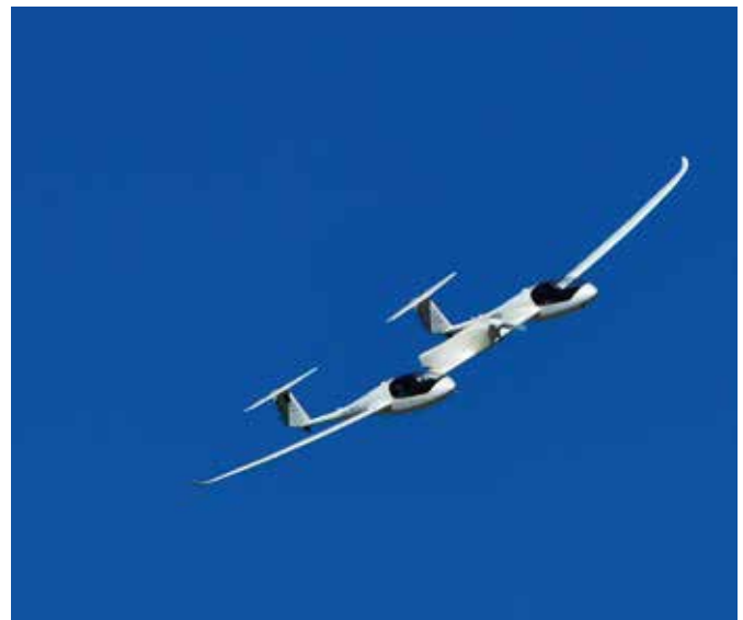
Die Hy4 ist weltweit das erste viersitzige Passagierflugzeug, das mit einem Wasserstoff-Brennstoffzellen-Batterie-System angetrieben wird. Absolvierter Erstflug im Jahr 2016.
