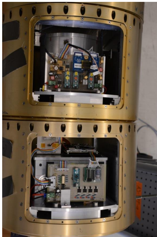
Abbildung 7: Biologische Nutzlasten auf Mapheus 8; Oben: MemEx – Experimenteinschub mit Hefeprobe und Strahlungsdetektor M-42; Unten: CellFix mit ROPUM und apex
