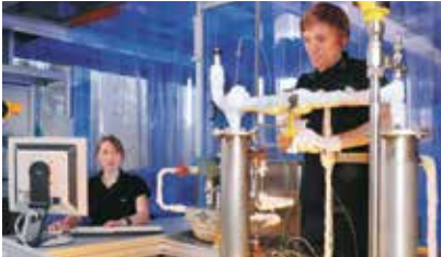
Laborteststand zur Wärmetransformation für einen Temperaturbereich von 80–200 °C
