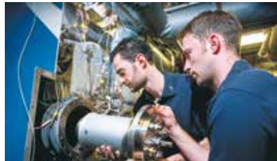
Einbau des Holzgas-FLOX®-Brennkammersystems in die Mikrogasturbine Turbec T100
