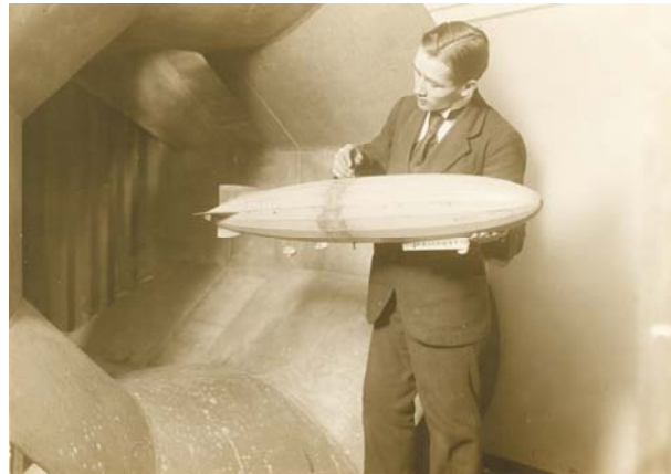
Modell des Zeppelin-Luftschiffs LZ 120 „Bodensee“ im Windkanal in Göttingen (1920)
