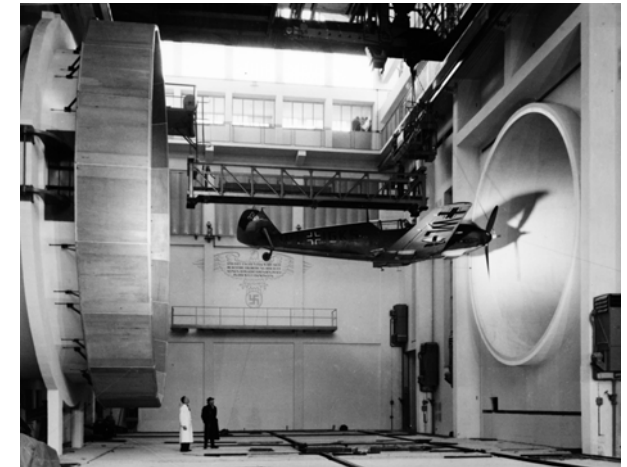
Jagdflugzeug Messerschmidt Me 109 in der Messstrecke des Hermann-Göring-Kanals Braunschweig (1940)
