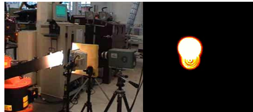
Prüfung einer flächigen Klebverbindung im kontinuierlichen Durchlauf
