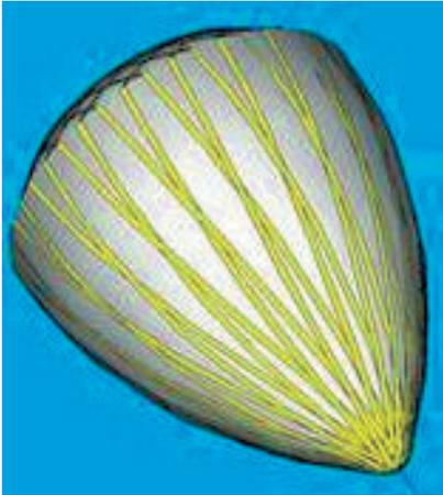
Wickelmuster eines Radome-Modells für Windkanaltests
