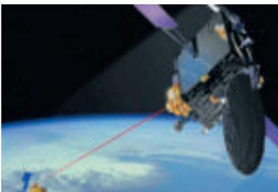
Messtechnik für direkte optische Datenverbindung zwischen Satelliten in Erprobung
