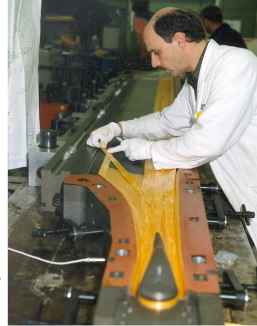
Blattfertigung in konventioneller Prepreg-Handablage
