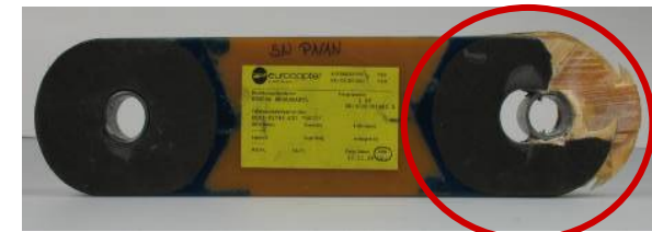
Lochleibungsfestigkeit: Simulation und experimentelle Validierung
