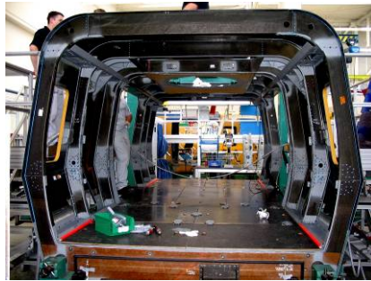
Vormontierte CFK Spantstruktur
