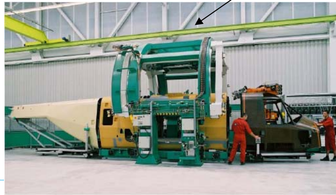
Automatisiertes Spleissen und Endmontage des NH90
