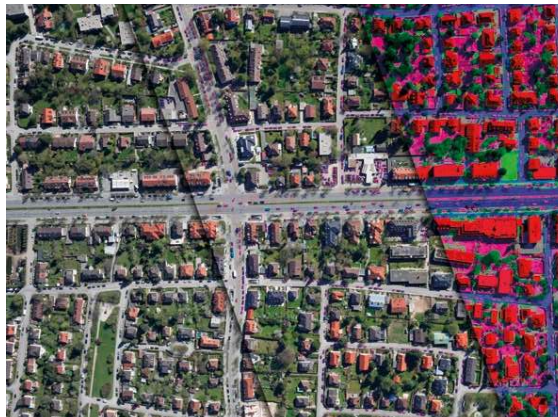
Künstliche Intelligenz wird eingesetzt, um Luft- und Satellitenbilder zu klassifizieren. So erkennt der Algorithmus Verkehrswege, Fahrzeuge und unterschiedliche Fahrbahnmarkierungen auf dieser Aufnahme einer Szene von München aus etwa 500 Kilometer Entfernung.
