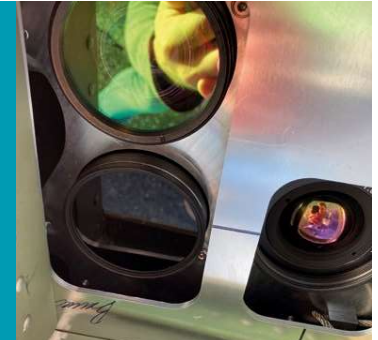
Der Sensorkopf der MACS-Kamera ist so klein, dass er durch eine Luke im Boden des Flugzeugrumpfes passt
