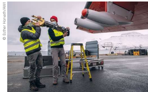
Manuel Moser und Valerian Hahn bereiten die Cloud Combination Probe vor, eine Wolkensonde zur Messung von Wolkentropfen und Eiskristallen
