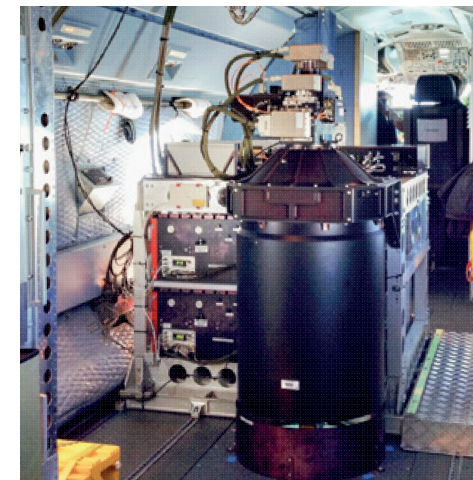
Das Aerosol- und Wasserdampf-Lidar des DLR-Instituts für Physik der Atmosphäre
