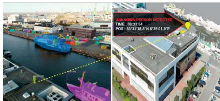
Dreidimensionales Echtzeitlagebild des Bremerhavener Hafens. Links: Kamerabilddaten mit Objekten, die mittels künstlicher Intelligenz automatisch erkannt und entsprechend ihrer Form eingefärbt wurden. Rechts: vorläufiges 3D-Modell der Umgebung mit Angaben der Position einer Person, die sich in einem potenziell gefährlichen Bereich befindet.
