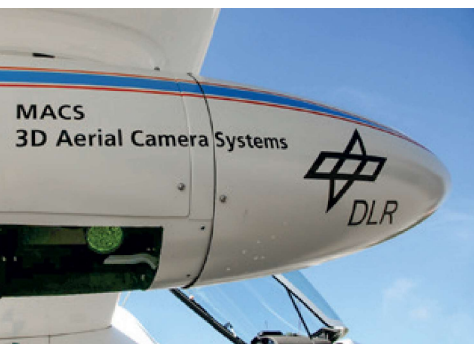
Die Luftbildkamera MACS (Modular Aerial Camera System) erstellte Aufnahmen des Hafengeländes in Bremerhaven für hochaufgelöstes Kartenmaterial
