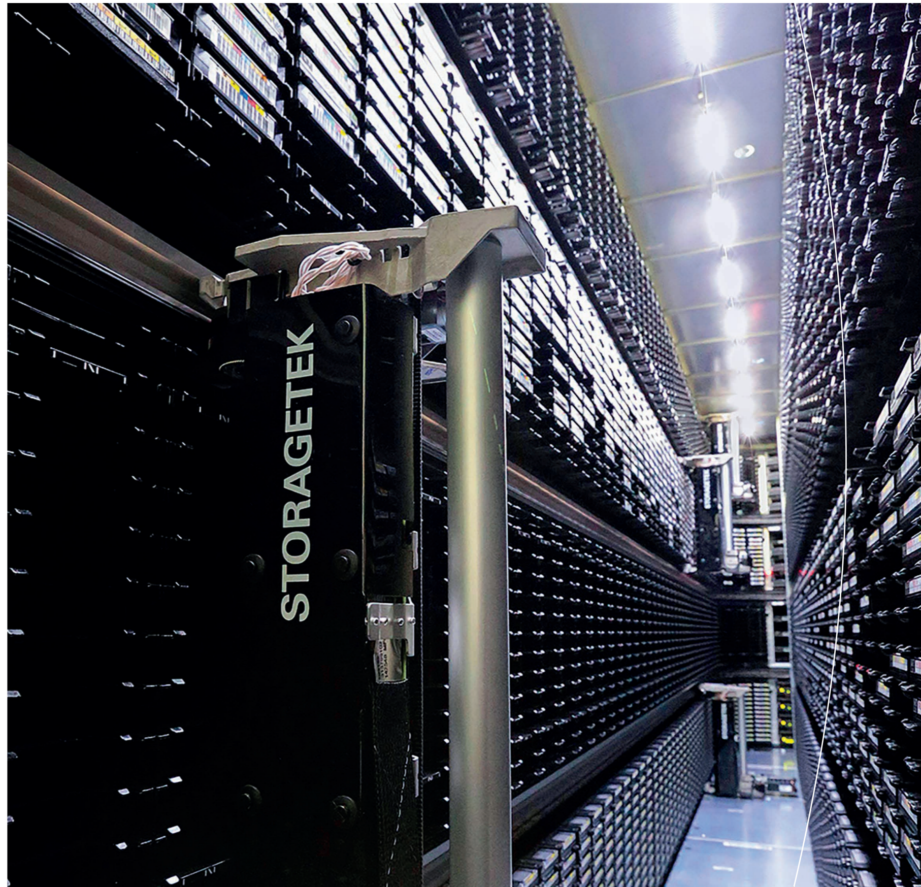
Das Deutsche Fernerkundungsdatenzentrum des DLR (DFD) betreibt in Oberpfaffenhofen das Deutsche Satellitendatenarchiv (DSDA). Im Auftrag der Europäischen Weltraumorganisation ESA baut das DFD ein Prozessierungs- und Archivierungszentrum auf: Das roboter-basierte DSDA speichert unter anderem die Bilddaten der zukünftigen Copernicus-Satelliten Sentinel-1 und Sentinel-3.
