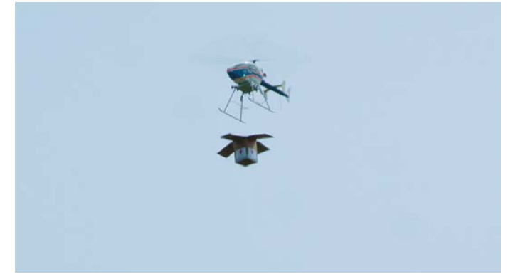
Die für Hilfeinsätze mit Drohnen angepassten Kartons entfalten sich automatisch beim Abwurf
