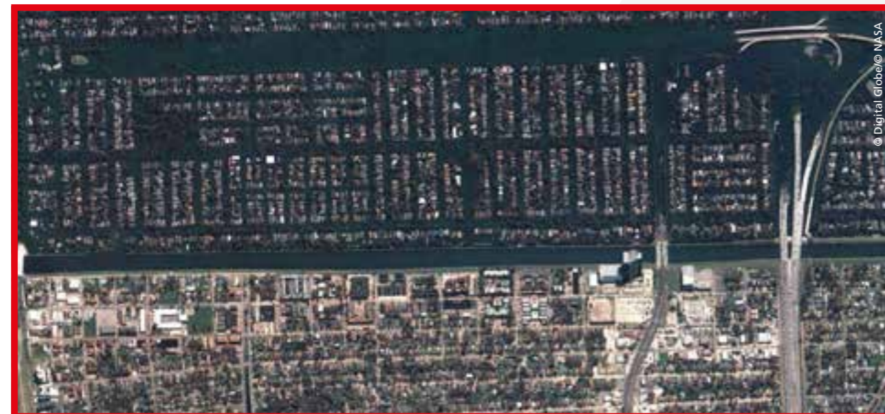
Während des Hurrikans Katrina kam es am 31. August 2005 in New Orleans zu zwei folgenreichen Damnbrüchen – einer davon im 17 th Street Canal in West New Orleans. Das 145 Meter lange Loch sorgte dafür, dass das Wasser den östlichen Teil flutete, während die westliche Nachbarschaft aber trocken blieb. Die Aufnahmen stammen von dem US-amerikanischen QuickBird-Satelliten.
