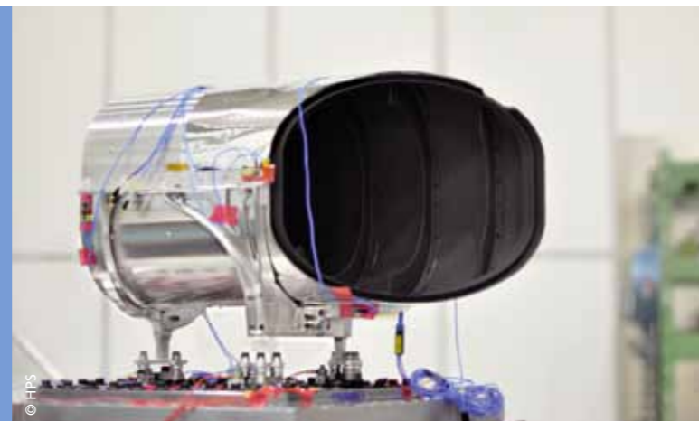
Im Auftrag der Kayser-Threde GmbH hat HPS dieses optische Leichtgewicht-Baffle für die deutsche EnMAP-Mission entwickelt.
