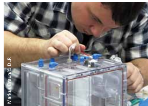
Behutsam werden die Filter und die Schläuche eingesetzt. Der Futterapparat für die Fische wird befüllt und danach das OmegaHab mit dem Hornkraut bepflanzt.
