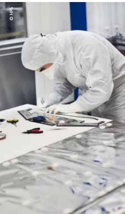
MLI-Fertigung bei HPS: Die Firma entwickelt, fertigt und integriert unter anderem die Isolation für das deutsche Teleskop eROSITA von MPE.
