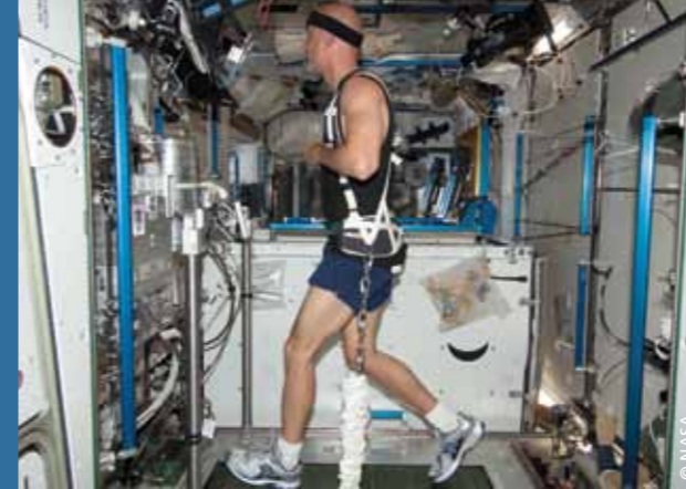
Luca Parmitano trainiert auf einem besonderen Laufband – dem Combined Operational Load Bearing External Resistance Treadmill (COLBERT) T2. Astronauten halten sich auf diesem speziellen Sportgerät fit und führen medizinische Versuche durch.
