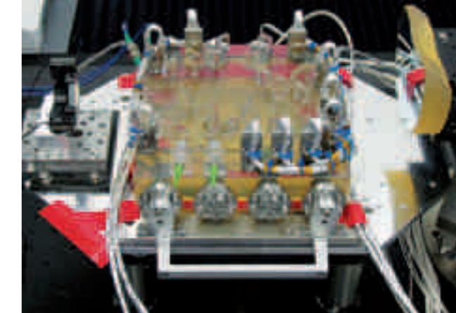
Die optische Bank des LTP ist das Herzstück des hochempfindlichen Interferometers von LISA Pathfinder.
