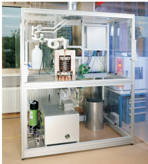
Laborteststand für thermochemische Speicher
