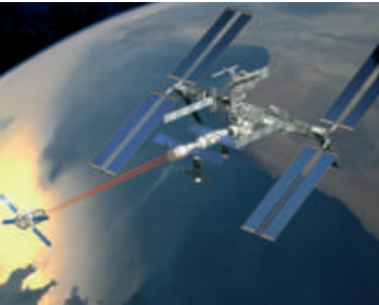
Die letzte Phase des Anflugs an die ISS vor dem Andocken in der Animation. Die Infrarotlaser des Telegoniometers sind hierbei stilisiert und mit dem menschlichen Auge nicht sichtbar.
