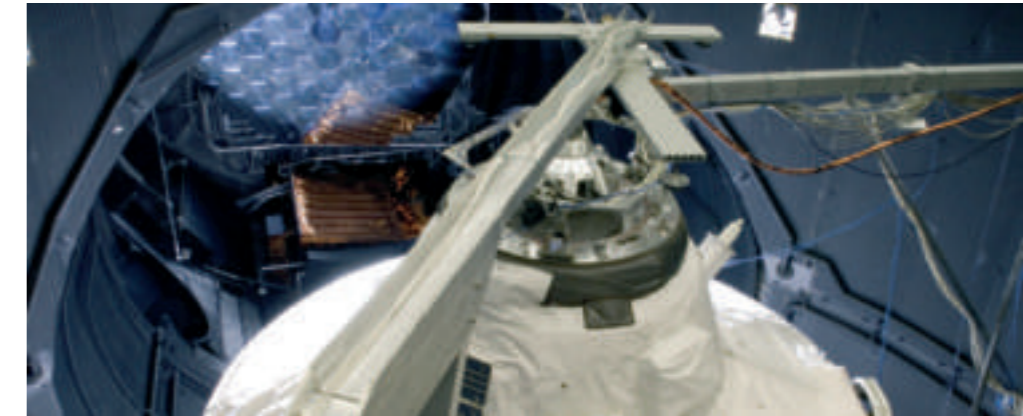
Bild links: Akustiktest in der LEAF-Kammer (Large European Acoustic Facility) bei ESTEC in Noordwijk
