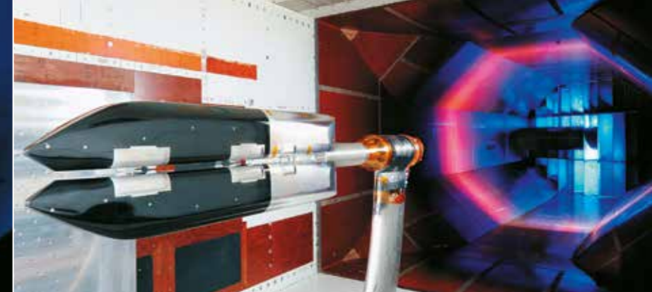
Mit diesem Zugmodell aus kohlenstofffaserverstärktem Kunststoff messen die DLR-Wissenschaftler unter anderem den Lärm eines Hochgeschwindigkeitszuges
