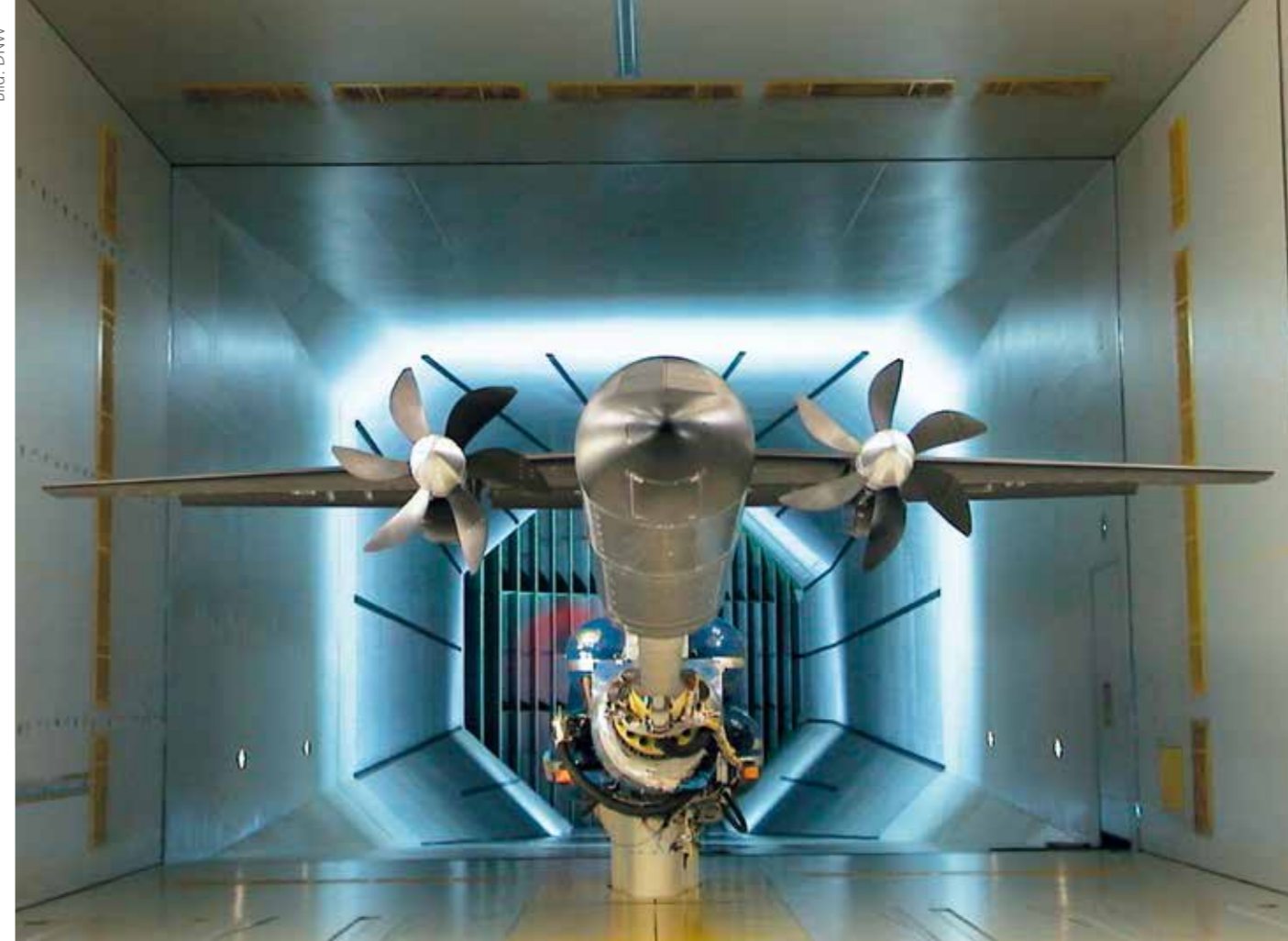
2014 wurden im DNW-LLF die Propeller des APIAN-Modells (Advanced Propulsion Integration Aerodynamics and Noise) vermessen
