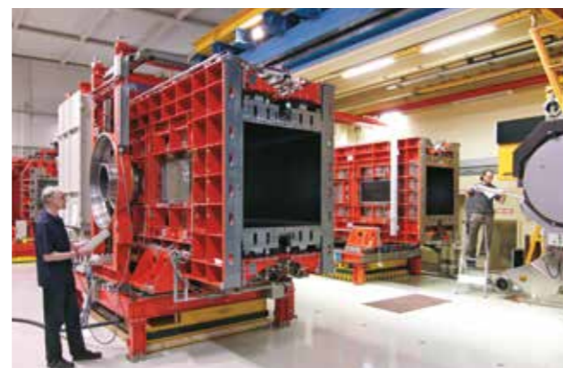
Je nach Bedarf können die Messstrecken des Transsonischen Windkanals auf Luftkissen (unter dem Messstreckenblock in Gelb zu erkennen) ausgewechselt werden
