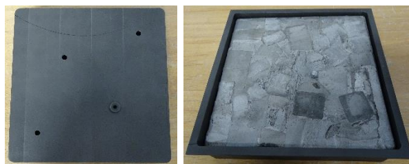
Abbildung 27: Draufsicht auf die defekte Graphithaube nach Erstinbetriebnahme und auf die Unterseite des Speichermaterials.
