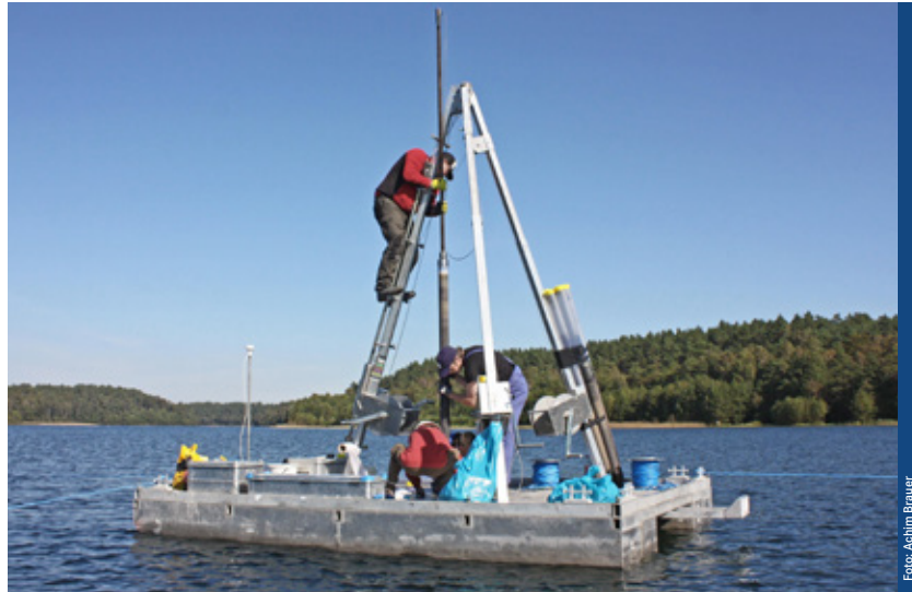
Im Rahmen von ICLEA entnehmen deutsche und polnische Wissenschaftler Sedimentproben aus Seen
