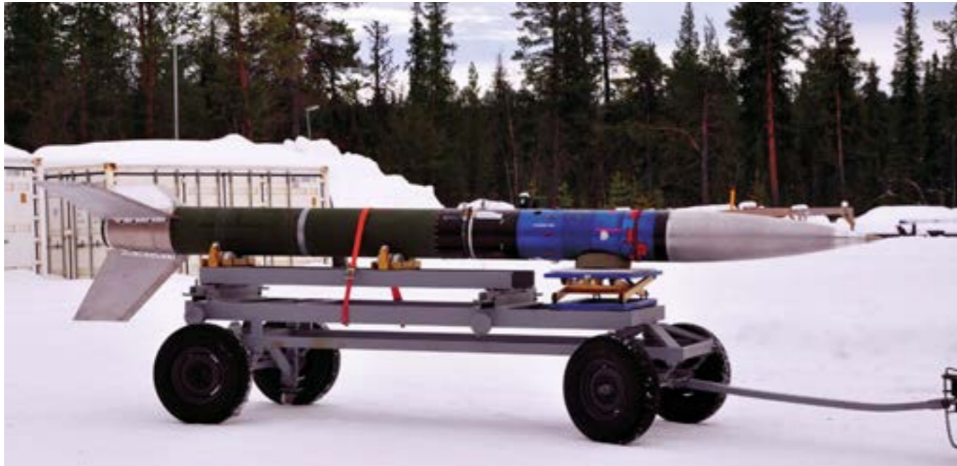
REXUS 22 ist fertig für den Roll-out. Nach Zusammenbau des Motors (grün) mit den Experimentmodulen (blau) wird die Rakete zum Startplatz gebracht.
