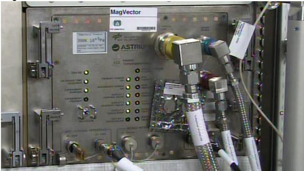
Das MagVector/MFX-Experiment ist angeschlossen und funktioniert tadellos. In diesem Experimenteinschub steckt eine ganz spezielle Probe: In einer kühlbaren Vakuumkammer liegt ein elektrischer Leiter mit veränderbarer Leitfähigkeit. Mit ihm können verschiedene Zustände nachgestellt werden. So haben die Forscher erstmals gemessen, wie sich die Magnetfeldstruktur um ihn herum verändert hat, während er um die Erde kreist.
