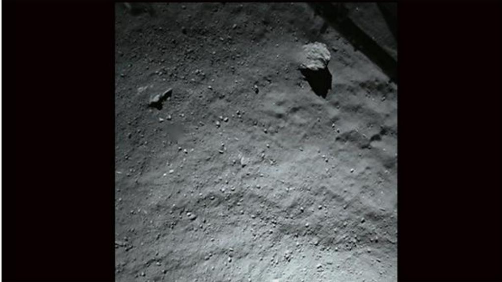
Dieses Bild wurde vom ROLIS-Instrument an Bord von Philae am 12. November 2014 in einer Höhe von etwa 40 Metern vor dem ersten Aufsetzen aufgenommen. Die Auflösung beträgt vier Zentimeter pro Pixel.
