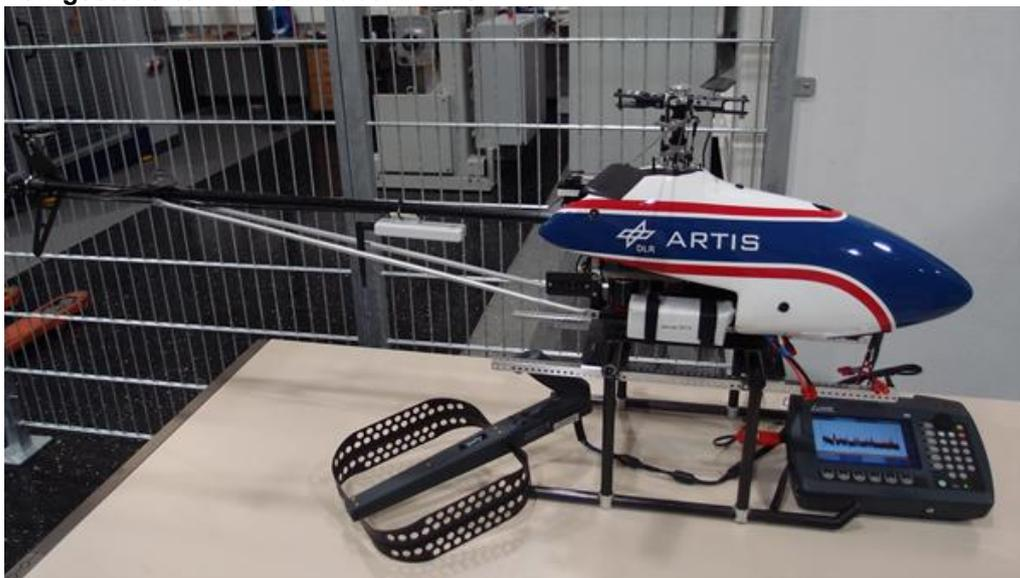
Einer der Hubschrauber der ARTIS-Familie des Instituts für Flugsystemtechnik. Links ist die Rahmenantenne zu sehen, unten rechts der mobile Spektrumanalyser.
