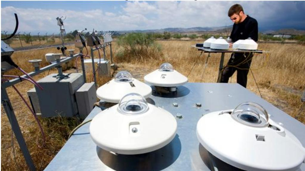
Mit Hilfe eines Rotating Shadowband Irradiometers misst ein DLR-Wissenschaftler die direkte Sonnenstrahlung.
