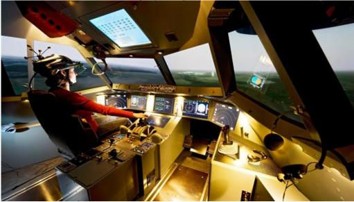
GECO ist ein modular aufgebauter Festsitz-Cockpitsimulator mit flugmechanischen Modellen der DLR-Flugversuchsträger. Dieses flugmechanische Modell kann je nach Anwendungsfall ausgetauscht werden.
