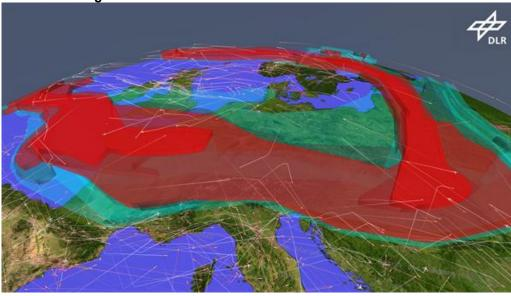
Möglicher Luftverkehr über Europa am 17.04.2010 bei verbesserter Aschevorhersage und unter Anwendung von Re-Routing-Verfahren, die auch Flüge von hochfliegenden Flugzeugen über der Aschewolke erlauben. Die Farbabstufungen in der Aschewolkendarstellung geben die vorhergesagten Asche-Konzentrationen an, eingeteilt nach den drei vom Vulcanic Ash Advisory Center (VAAC) in London empfohlen Konzentrationsstufen: low (Cyan), medium (Grau), high (Rot).
