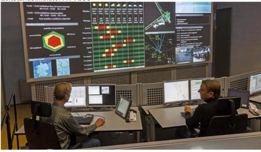
ACCESS (Airport and Control Center Simulator) bildet eine Managementzentrale mit Arbeitsplätzen für verschiedene Operateure an Flughäfen nach. Das Institut für Flugführung nutzt den Simulator beispielsweise für die Erforschung kooperativer Flughafenprozesse, mit denen zukünftig großflächige Störungen im Luftverkehr besser abgefedert warden sollen. (Software-Suite im Foto: TAMS Consortium).
