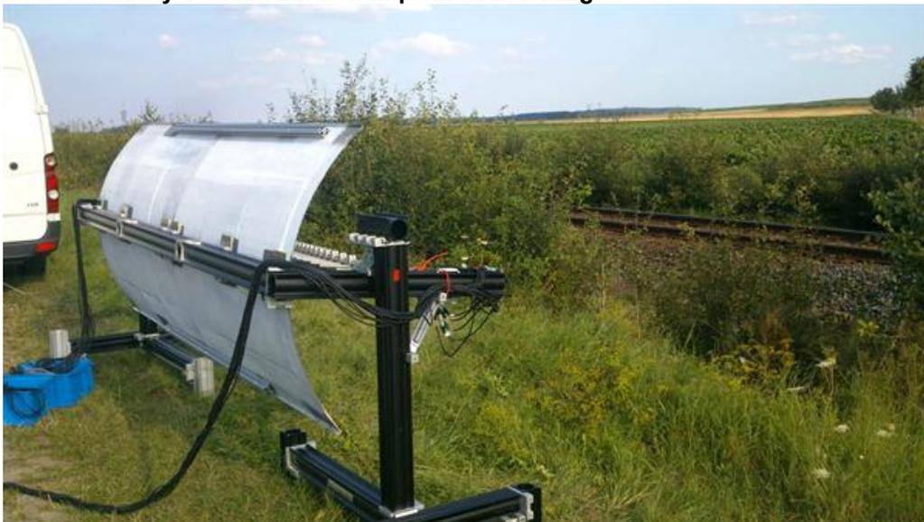
Optimiert für den Schienenverkehr: Mikrofon-Array Technik zur Schallquelllokalisierung.
