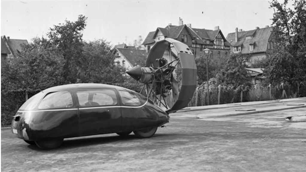
Der Zweite Weltkrieg machte jegliche Pläne für eine Weiterentwicklung von Personenkraftwagen zunichte. 1942 wurde der Schlörwagen mit einem Propeller aus der russischen Kriegsbeute mit 130 PS ausgestattet. Die ungewöhnliche Konstruktion erregte auf einer Testfahrt in Göttingen großes Aufsehen.
