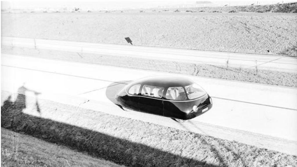
Auf der damals bei Göttingen gerade fertig gestellten Autobahn, dem Vorläufer der heutigen A 7, absolvierte der Schlörwagen im Jahr 1939 eine Reihe von Testfahrten. Die Höchstgeschwindigkeit betrug beim Serienwagen circa 105 Kilometer pro Stunde, beim Stromlinienwagen beachtliche 134 bis 136. Der Schlörwagen verbrauchte auf 100 Kilometer acht Liter, das Serienmodell hingegen zehn bis zwölf Liter - eine Reduzierung um 20 bis 40 Prozent.
