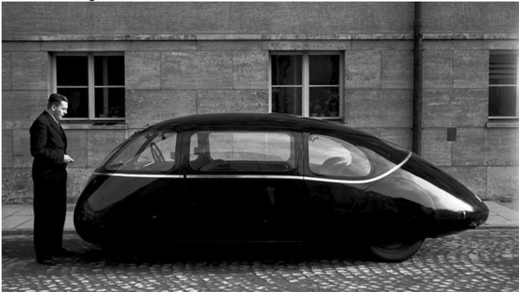
Vor 75 Jahren stellten Strömungsforscher der Aerodynamischen Versuchsanstalt Göttingen (AVA) ein Auto vor, das lange Zeit als konsequenteste Umsetzung der Aerodynamik im Fahrzeugbau galt: den so genannten Schlörwagen.
