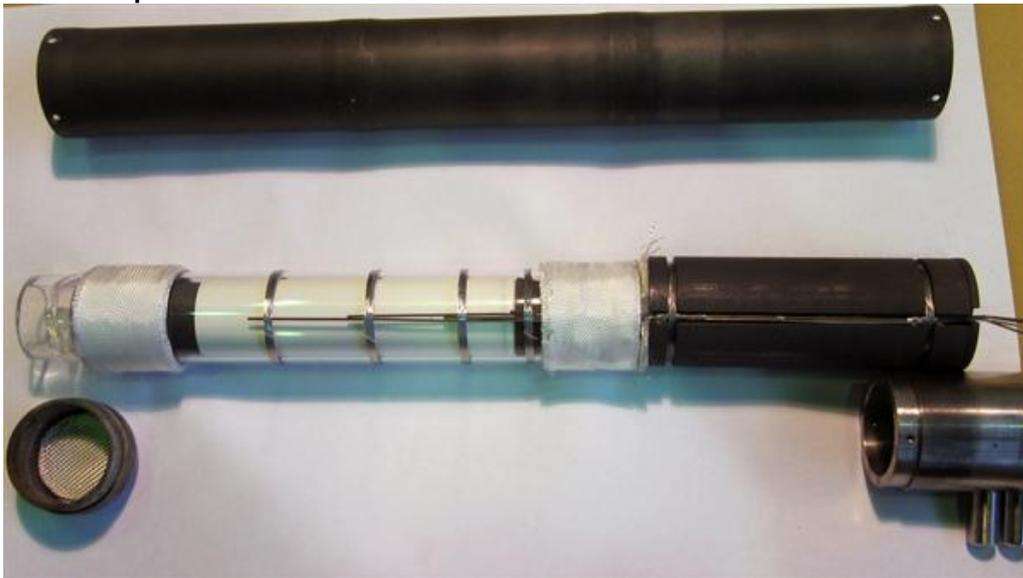
Der Außendurchmesser des zusammengebauten Experiments beträgt vier Zentimeter, die maximale Länge 35 Zentimeter.
