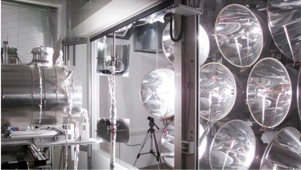
Mit einer Leistung von rund 200 Kilowatt und Bestrahlungsstärken von etwa 4 Megawatt pro Quadratmeter, ist der Jülicher Hochleistungsstrahler zehnmal so leistungsfähig wie sein Kölner Pendant. Die von zirka 80 Lampen und Reflektor-Modulen bereitgestellte Lichtintensität entspricht in etwa dem viertausendfachen der natürlichen Sonnenstrahlung auf der Erdoberfläche.
