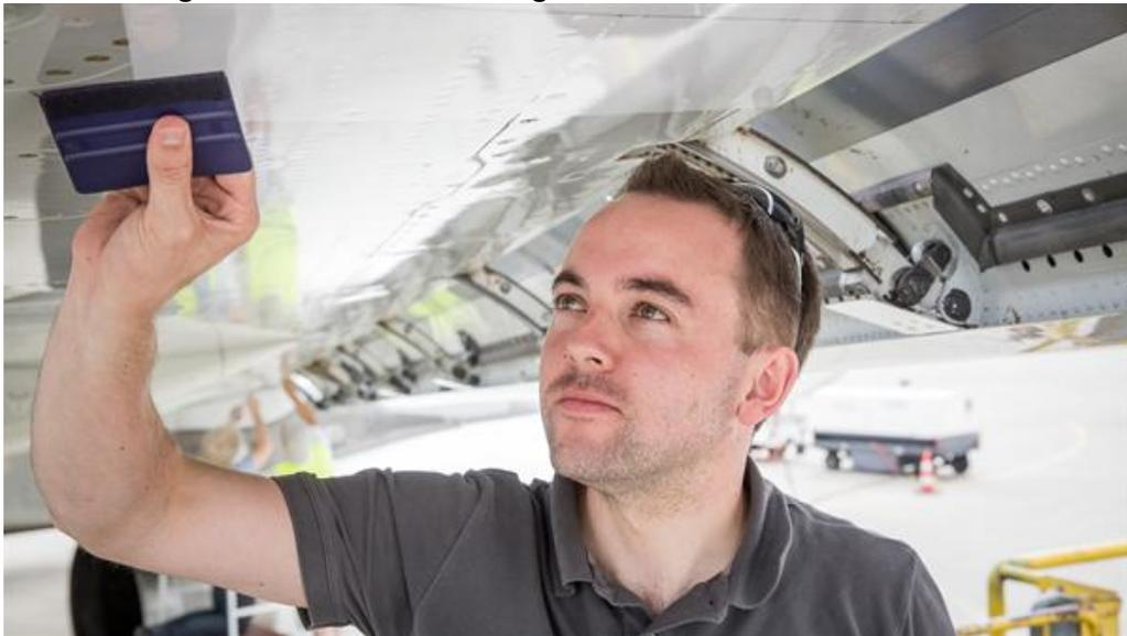
Im Laufe der Flugversuche sammelt Forscher Gloß die Insektenverunreinigungen auf Klebefolien, die hinter den Vorderkantenklappen auf den Tragflächen aufgeklebt sind. Nach einem Flugtag wandern die Folien direkt ins Labor und werden dort auf Scannern digitalisiert.
