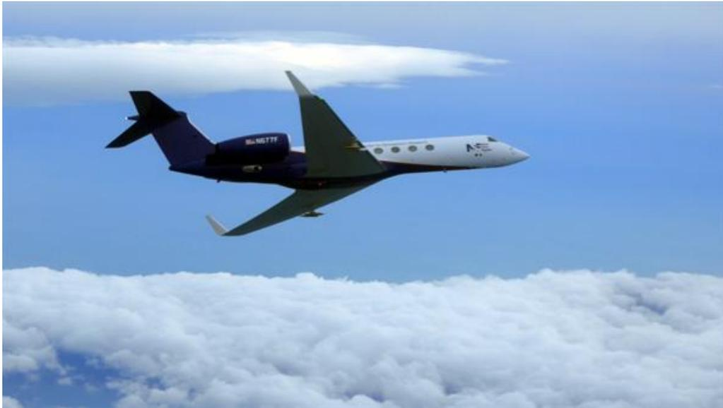
Mit einem nach oben blickenden LIDAR fliegt die Gulfstream V des US-amerikanischen NCAR, um den Wellenverlauf in der mittleren Atmosphäre zu verfolgen.
