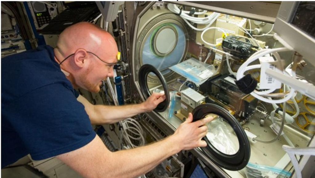
Astronaut Alexander Gerst arbeitet mit Proben und der Apparatur für ein Verbrennungsexperiment mit dem Namen "Burning and Suppression of Solids (BASS)" in der Forschungsvorrichtung Microgravity Science Glovebox (MSG) im Destiny-Labor der Internationalen Raumstation.
