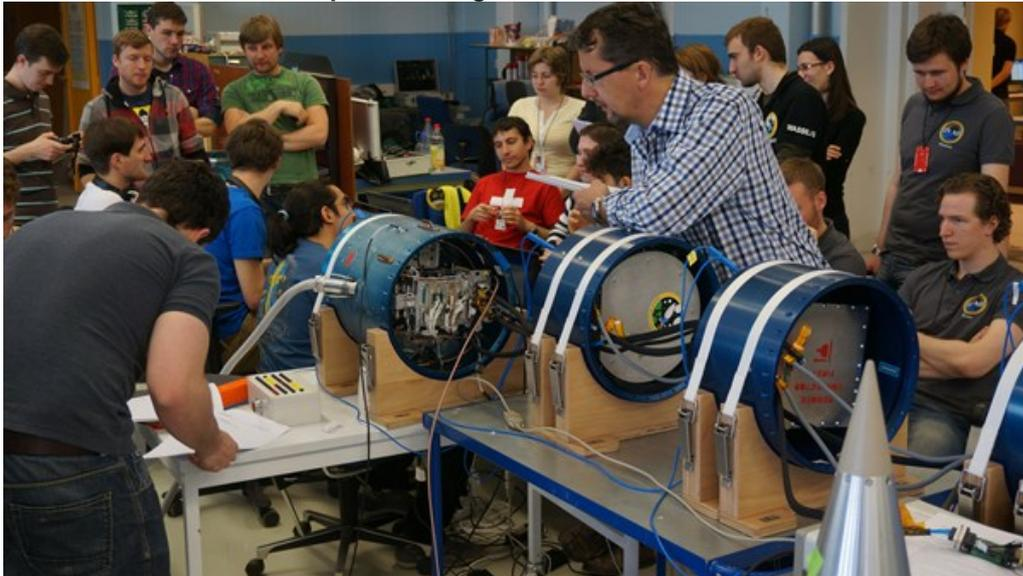
In der Raketenhalle am Startplatz Esrange verfolgen die Studententeams von REXUS 16 aus Deutschland, Rumänien, Belgien und Italien mit Spannung den Kommunikationstest zwischen ihren Experimentmodulen und dem Service-Modul (Mitte). Rechts unten im Bild ist die Raketenspitze zu sehen.
