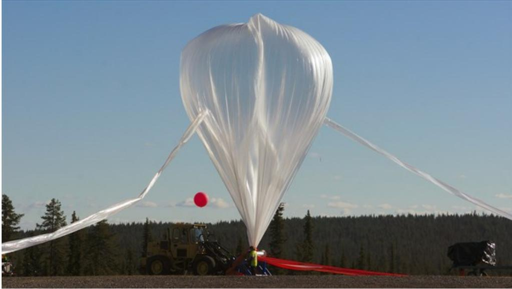
Der BEXUS-14-Ballon wird mit Helium gefüllt und ist bald bereit für den Start. Mit den roten Wetterballons wird vorher mehrfach überprüft, ob die Windverhältnisse dafür geeignet sind.
