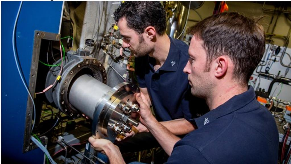
Um das Potenzial von Biomasse für die nachhaltige Energieversorgung besser zu erschließen, haben Forscher vom DLR-Institut für Verbrennungsforscher ein neues Brennkammersystem entwickelt, das eine hocheffiziente und schadstoffarme Verbrennung von Biomasse in einem Mikrogasturbinen-basierenden Blockheizkraftwerk ermöglicht.
