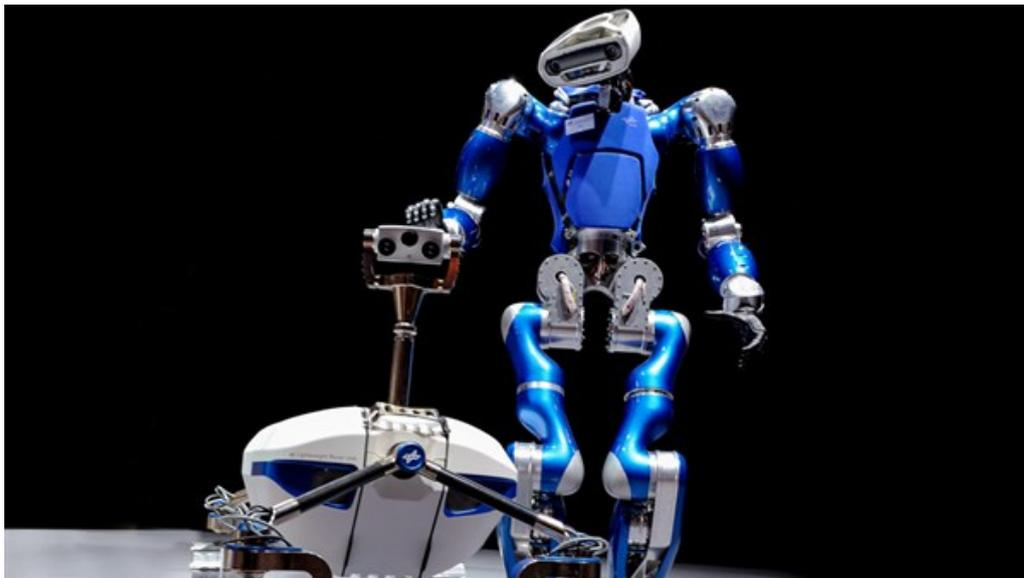
Sie erinnern an C3PO und R2D2: Der humanoide DLR-Laufroboter TORO kann sich auch in unwegsamem Gelände bewegen. Er ist 1,75 Meter groß, wiegt 76 Kilogramm und kann sprechen. Der erste teilautonome DLR-Rover ist der Prototyp eines Roboters zur Exploration von Mond und Mars. Er kombiniert viele modernste Technologien, die am Institut für Robotik und Mechatronik entwickelt worden sind. TORO und der Mond-Rover sind noch bis Sonntag, 25. Mai, im Space Pavilion der ILA Berlin Air Show 2014 unterwegs.
