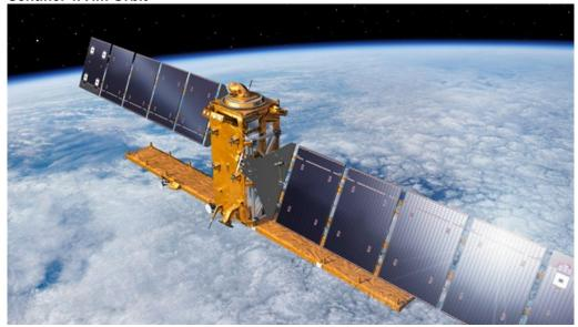
Sentinel-1A ist der erste Satellit des europäischen Erdbeobachtungsprogramms Copernicus. Am oberben Ende des Satelliten ist die runde Struktur des LCT montiert - einer neuartigen Kommunikationstechnologie.
