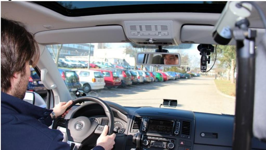
Die in den Testfahrzeugen verbaute Technik gibt Informationen zur Fahrzeugbewegung, zum Fahrer und zur unmittelbaren Umgebung, wie beispielsweise Geschwindigkeit, Verzögerung, Augen-, Kopf- oder Handbewegungen oder auch zu Abständen und der Verkehrsdichte. Sie ähnelt dem im Bild zu sehenden Aufbau.
