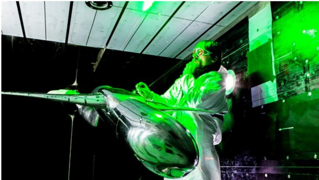
Bei den jetzt durchgeführten Tests kommt die Lasermesstechnik PIV (Particle Image Velocimetry) zum Einsatz.
